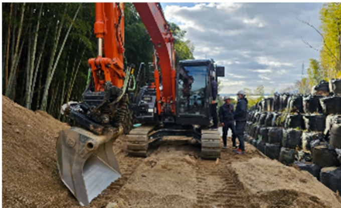
図-11 バケットが 360° 回転可能なチルトローテータ重機
