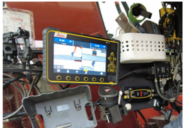
図-14 重機内のマシンガイダンスの様子
