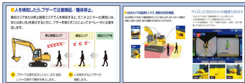
図3 人検知衝突軽減システム
