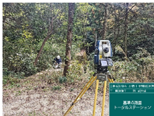
図-10 従来の2名1組のTSでの測量風景
