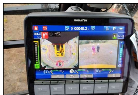
写真-7 バックホウ搭載カメラ
