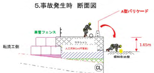
事故発生時の現場状況
