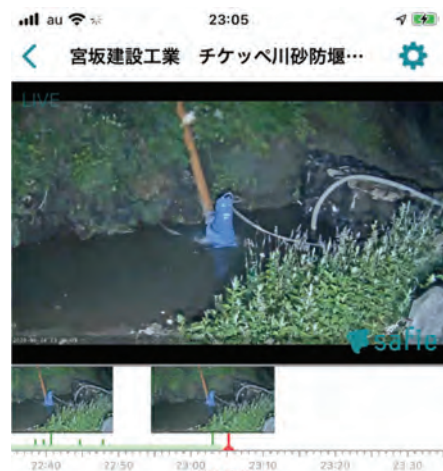
写真-6 スマホによる夜間遠隔監視
