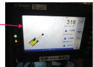
写真 4. バックホウ内のモニター
