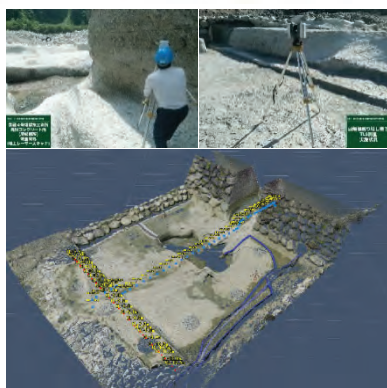
写真-9 T L S 測量状況
