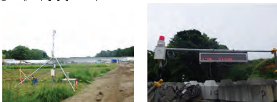
写真-2 ZEROSAI (雨量・風速・温湿度)
