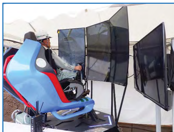
写真-4 遠隔操作コックピット
